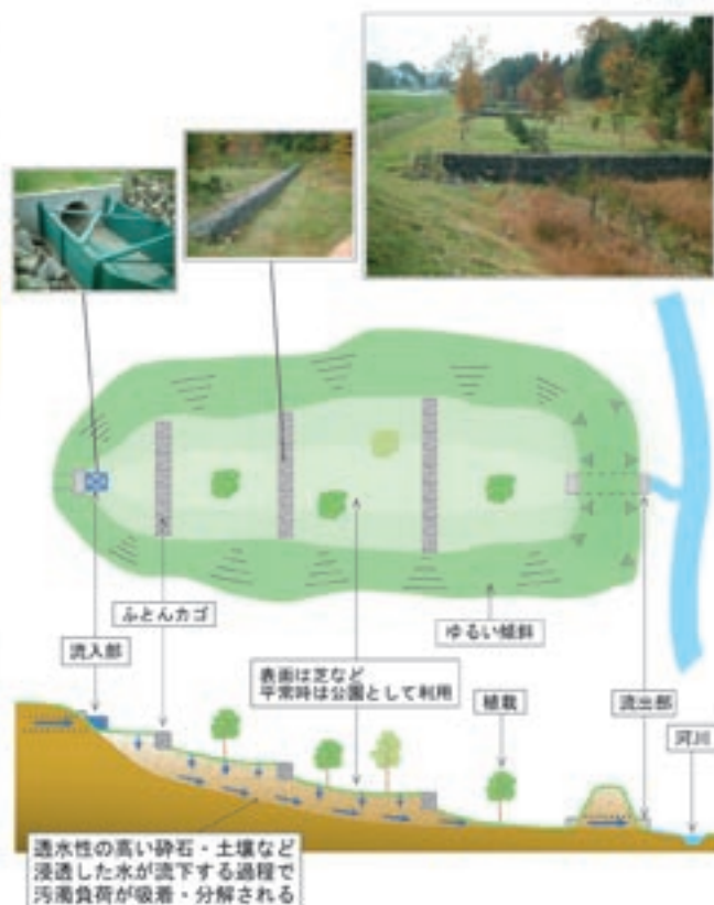
浸透・浄化機能を持った雨水調整池 †
