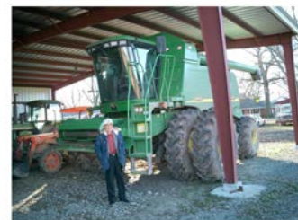
図5 大型のコンバインハーベスタ。前方に10m以上の刈取部を付けてコメ・麦等を収穫する
